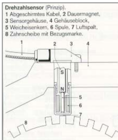
Abbildung von Bosch Rpm Signalpickupn mit Function-Prinzip and Anschlussbelegung.
